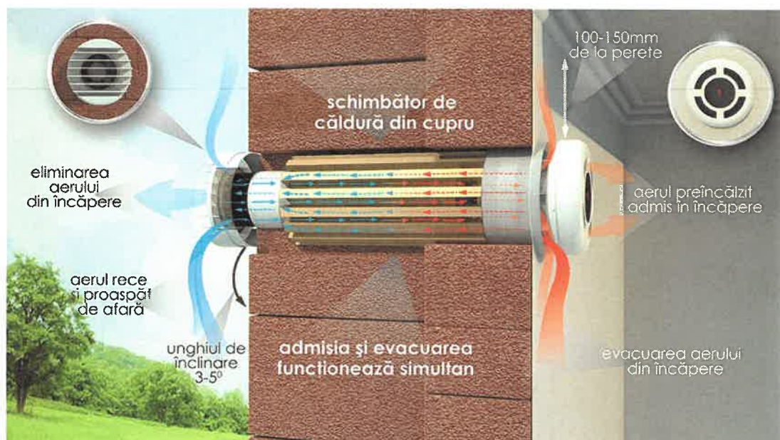
PRINCIPIUL DE FUNCȚIONARE AL RECUPERATORULUI
